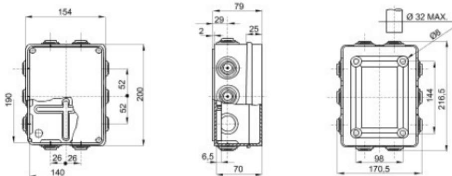
**Abmessungen Installationsgehäuse GW 4407**
