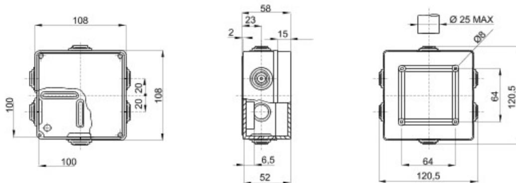
**Abmessungen Installationsgehäuse GW44004**
