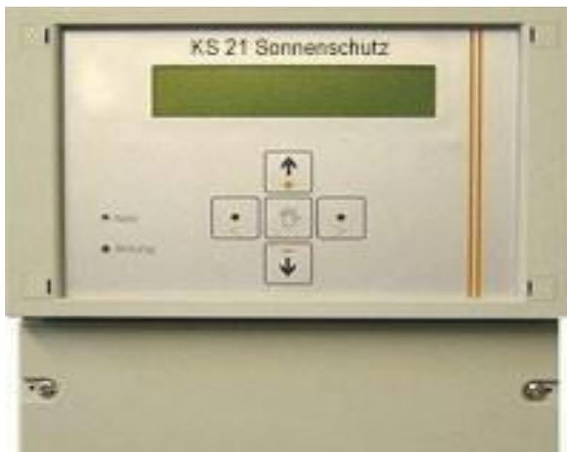
Mikroprozessorsteuerung zur Ansteuerung und Überwachung von wahlweise zwei unabhängigen Motoren oder zwei Gruppen von 230V-AC-Motoren, geeignet für elektrisch betriebene Jalousien, Markisen, Rolläden oder Fenster inkl. frei konfigurierbarem Sonne-, Wind-, Regen-, Temperatur- und Schaltuhrenprogramm.
