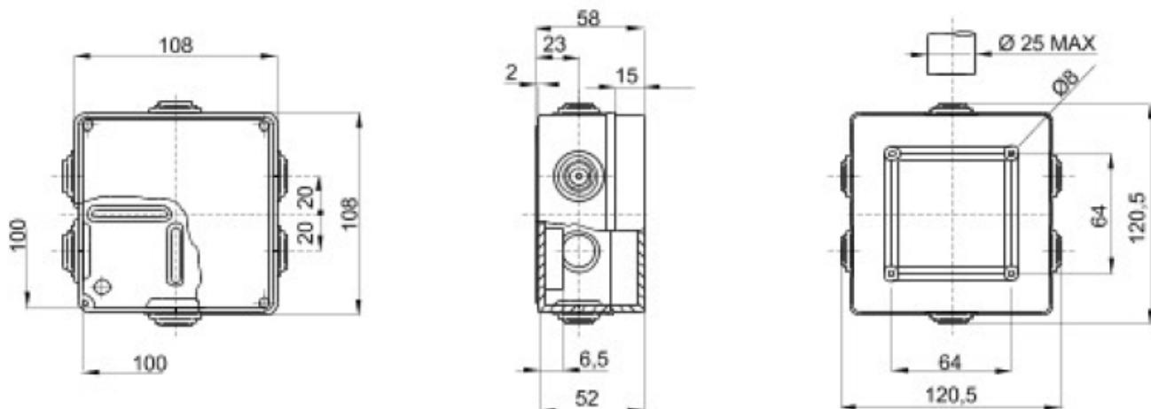
Abmessungen Installationsgehäuse GW 44004
