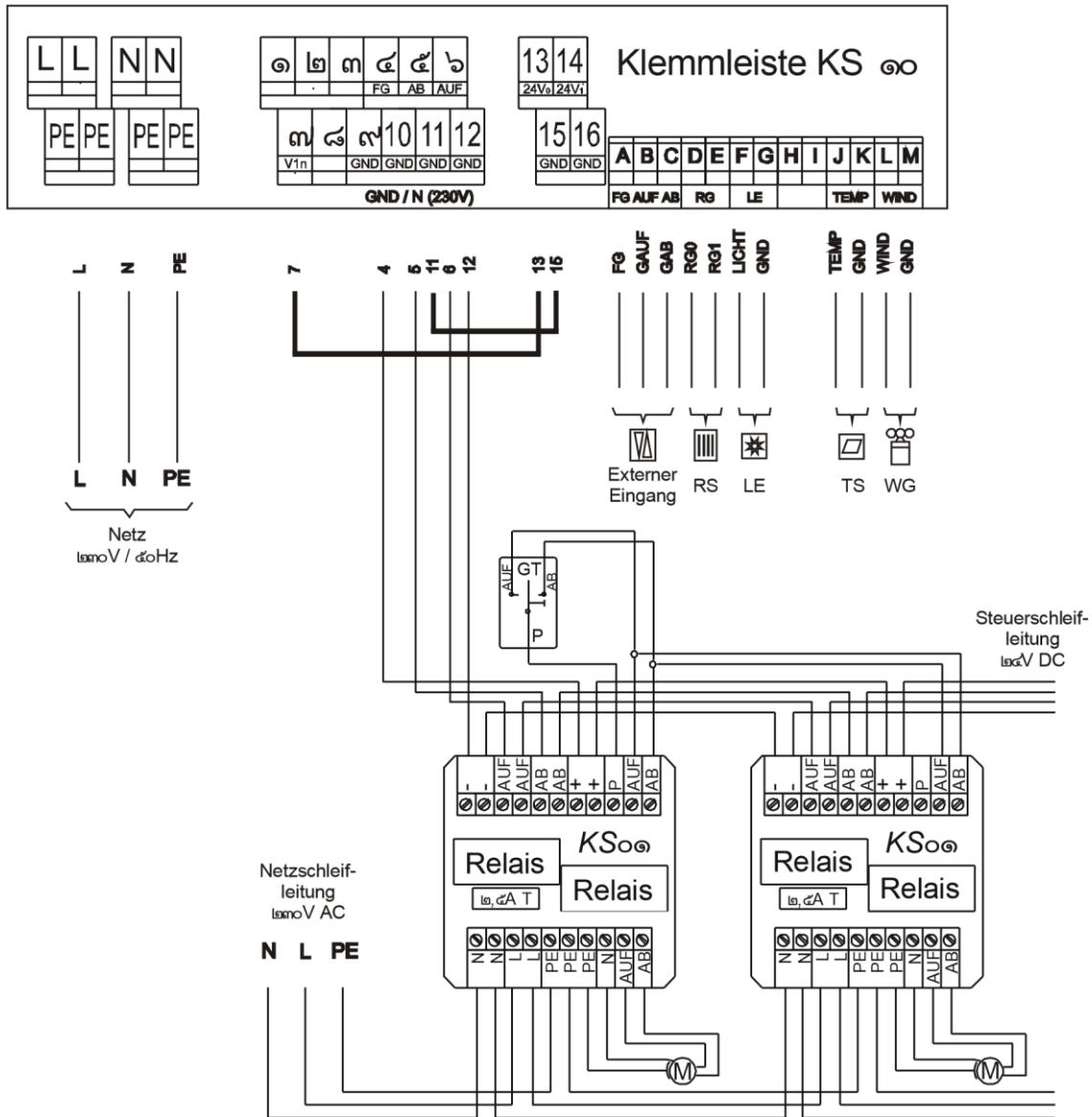
Für die Ansteuerung der Motorsteuereinheiten über den 24V Steuerausgang sind zwei Brücken (Brücke 1: 7 auf Klemme 13 und Brücke 2: 11 auf Klemme 15) anzuschließen. In diesem Fall werden über diese Brücken 24V geleitet. Es ist ein Querschnitt von mind. 0,8mm<sup>2</sup> zu wählen.
