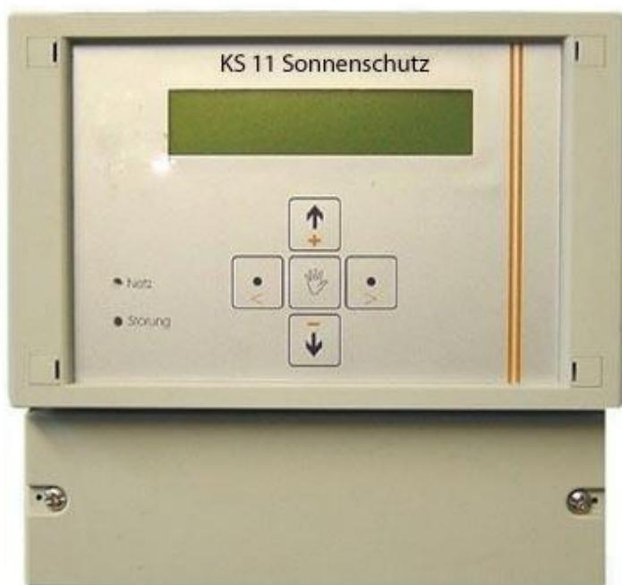
Mikroprozessorsteuerung zur Ansteuerung und Überwachung von wahlweise einem oder einer Gruppe von 230V-AC-Motoren, geeignet für elektrisch betriebene Jalousien, Markisen, Rolläden oder Fenster inkl. frei konfigurierbarem Sonne-, Wind-, Regen-, Temperatur- und Schaltuhrenprogramm.
