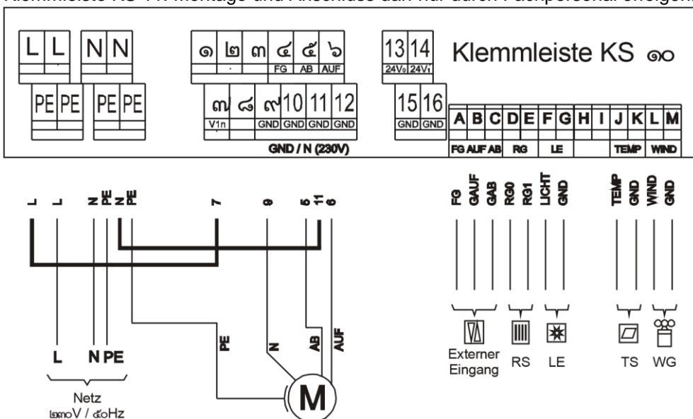
Für die Ansteuerung des Motors über den 230V Steuerausgang sind zwei Brücken (Brücke 1: L auf Klemme 7 und Brücke 2: N auf Klemme 11) anzuschließen. Da über diese Brücken 230V geleitet werden, ist ein Querschnitt von mind. 1,5mm<sup>2</sup> zu wählen.
