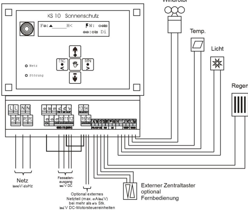
Bei der Entwicklung der Sonnenschutz-Zentrale KS11 wurde insbesondere auf Flexibilität in Bezug auf die Möglichkeit unterschiedlicher Anschlussvarianten Wert gelegt. Sie haben die Möglichkeit einen einzelnen 230V-Sonnenschutzmotor direkt an die Zentrale anzuschließen. Wollen Sie mehr als einen Motor mit der Zentrale KS11 betreiben, so können Sie wahlweise auf 230V-Gruppensteuerungen oder 24V-Motorsteuereinheiten zurückgreifen.
