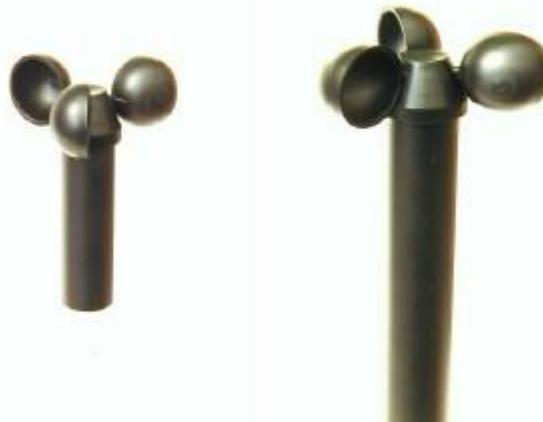
Der Windsensor muss so montiert sein, dass er nicht im Windschatten eines Gebäudeteils (z.B. Schornstein oder Fahrstuhlschacht) liegt.
