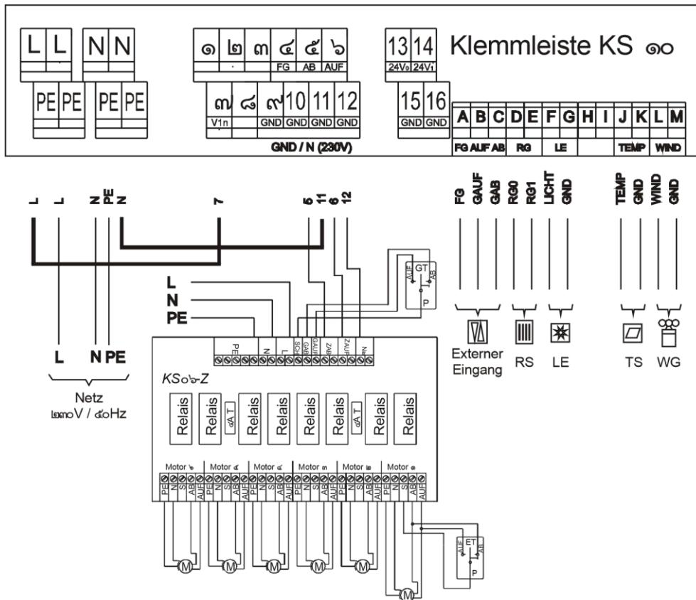
Für die Ansteuerung der Gruppensteuerungen über den 230V Steuerausgang sind zwei Brücken (Brücke 1: L auf Klemme 7 und Brücke 2: N auf Klemme 11) anzuschließen. Da über diese Brücken 230V geleitet werden, ist ein Querschnitt von mind. 1,5mm<sup>2</sup> zu wählen.
